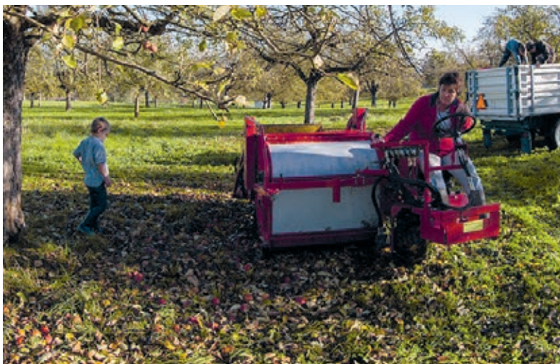
Une ramasseuse automotrice permet d'augmenter fortement la vitesse de la récolte.
